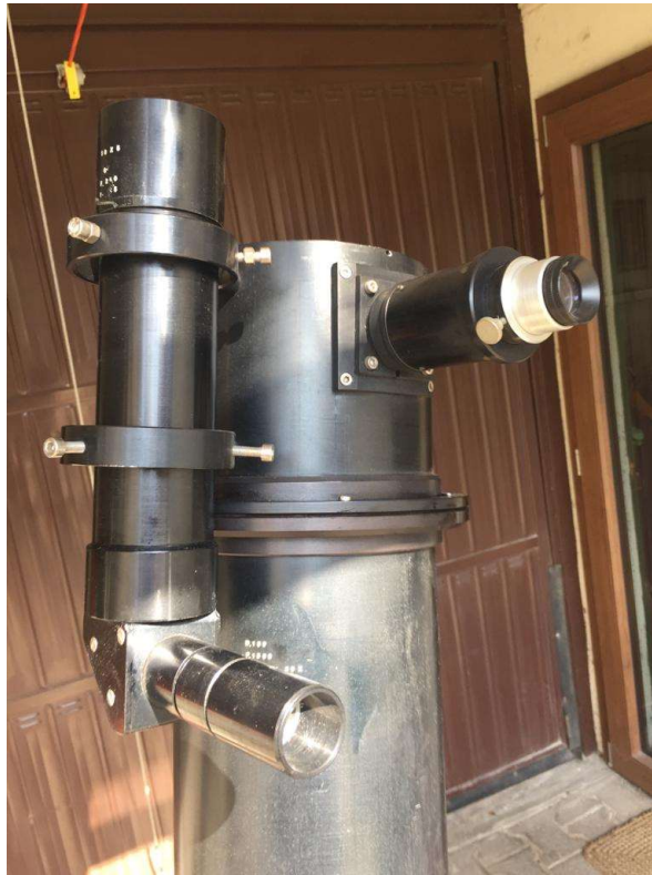
Fig. 5 – Torretta ruotante con oculare e cercatore
