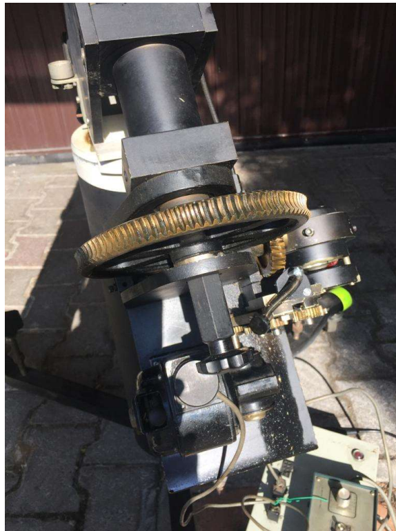
Fig. 4 – Asse orario con ingranaggi e motori
