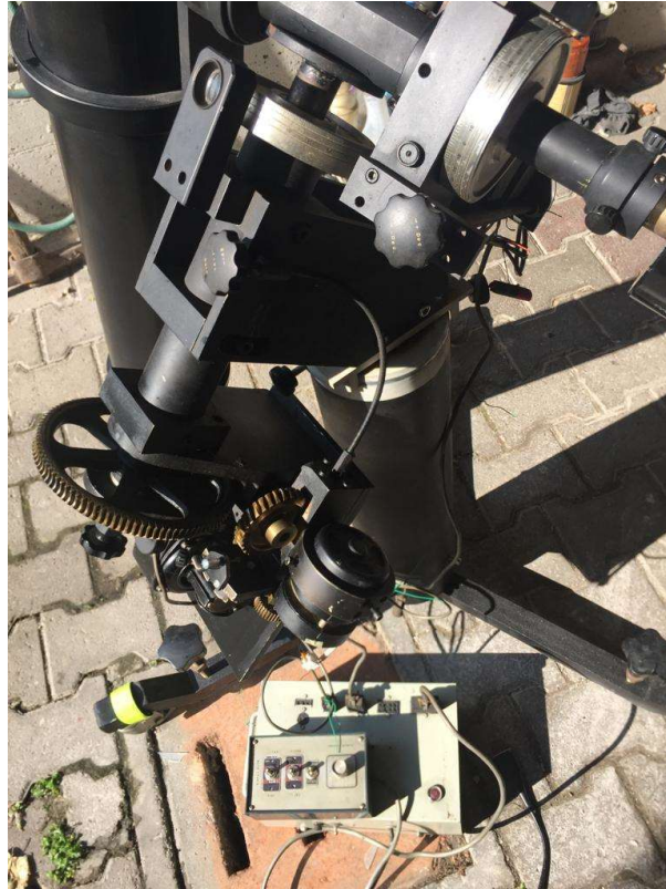
Fig. 6 – Asse orario, asse di declinazione, cerchi graduati e comandi motori
